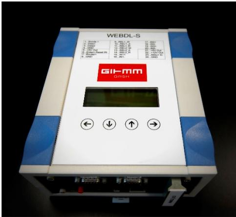
„WEBDL2“ ist ein universelles Datenspeichersystem bestehend aus Hard- und Software. Das System basiert auf einer ARM9-CPU und verfügt über ein Linux Betriebssystem.
